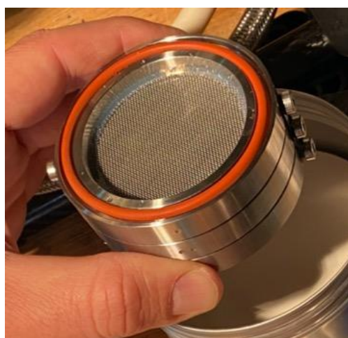
図5 MP サンプラーの3連フィルターユニット。海水中のマイクロプラスチックは、上から 300, 100, 30 \mu m 目合のフィルター上に順々に捕集される。
